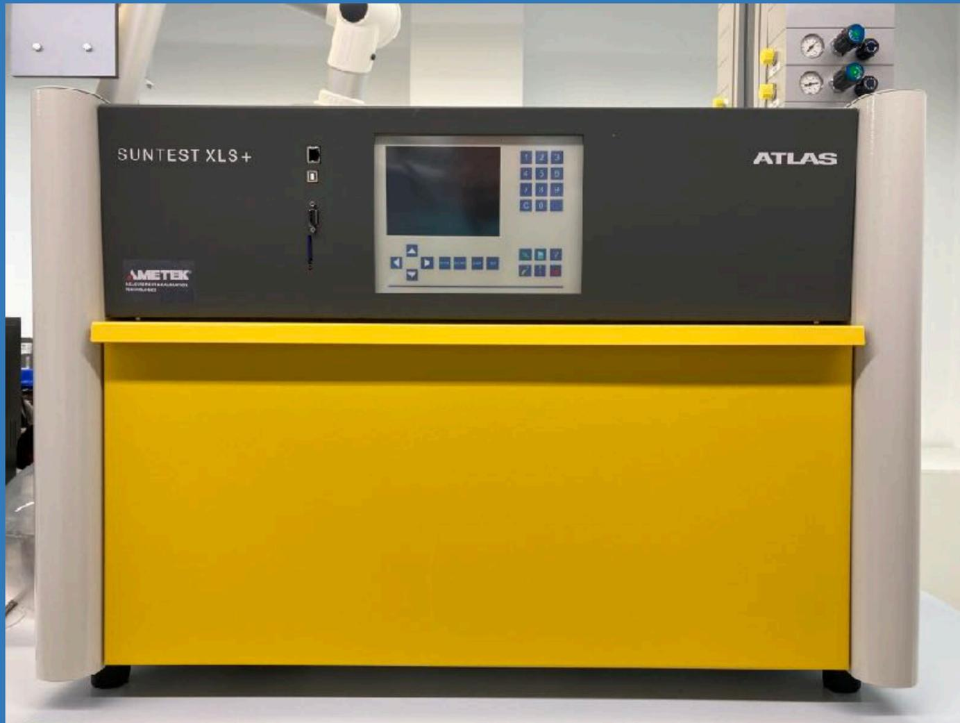
*Sistemas conformados por cámaras compactas para probar de forma acelerada la resistencia de materiales a la luz solar y la temperatura. Permite conocer los cambios en las propiedades de los materiales que ocurrirían en el transcurso de meses o años.*
