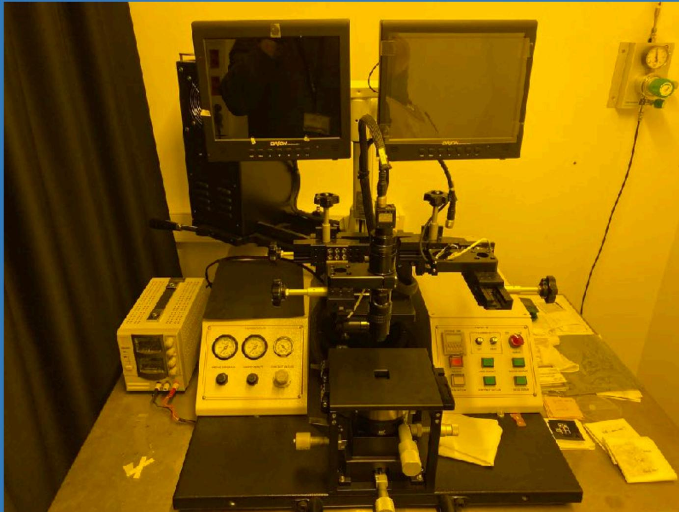
*El sistema de fotolitografía óptica de alta precisión usado para la fabricación de semiconductores, que traslada el diseño de un patrón (generalmente de tamaño micro- o nanométrico) a un determinado sustrato fotosensible. Para el vaciado del sustrato se emplea radiación ultravioleta*
