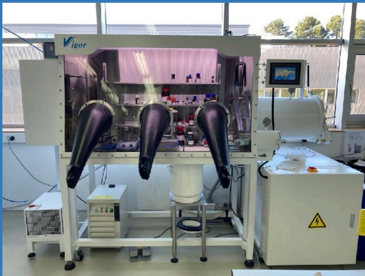
*Espacios de trabajo estancos que poseen una atmósfera de gas inerte en su interior, lo que permite el trabajo con compuestos o materiales sensibles al oxígeno o la humedad del aire, o otros agentes ambientales. Están diseñadas para la manipulación y almacenamiento de sustancias, y para la realización de reacciones químicas en su interior*
