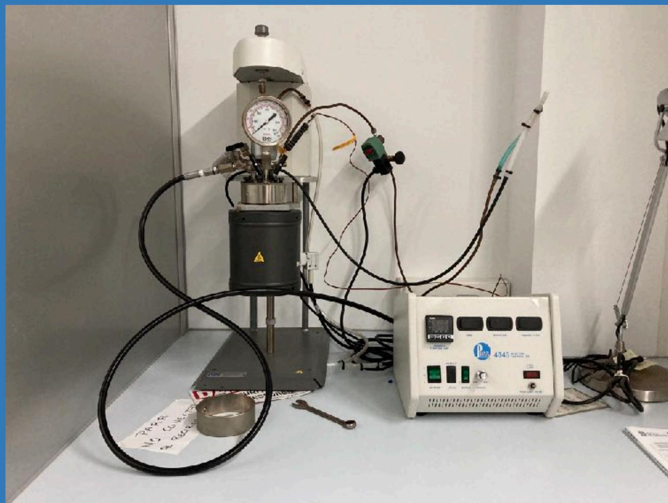
*Sistema dedicado a la realización de reacciones que requieren elevadas presiones, generalmente con atmósfera de hidrógeno, de forma segura para los investigadores.*
