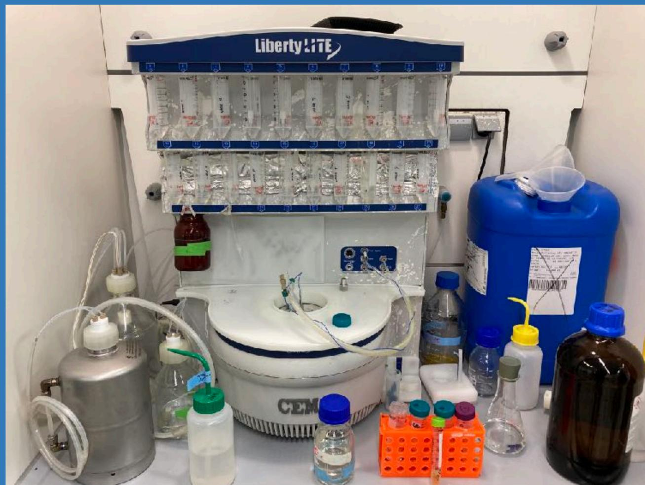
*Instrumentos diseñados para automatizar y optimizar la síntesis de péptidos en fase sólida. Acoplado a un reactor de microondas, permite la realización de secuencias peptídicas largas (hasta 80 aminoácidos) en tiempos cortos (menos de 1 día) con buenos rendimientos y baja generación de residuos*
