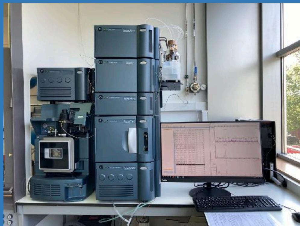
*Técnica que emplea fluidos en estado supercrítico (generalmente  $CO_2$ ) como fase móvil. Permite obtener separaciones con alta resolución en tiempos muy cortos, y es compatible con una gran variedad de compuestos. Combinada con un detector de masas se convierte en una técnica ideal para la identificación y cuantificación de hidrocarburos poliaromáticos de elevado peso molecular*
