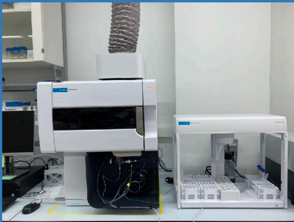
*Técnica de análisis multielemental que permite la identificación y cuantificación de la gran mayoría de los elementos de la tabla periódica dentro de matrices complejas, empleando un plasma de acoplamiento inductivo como fuente de ionización*
