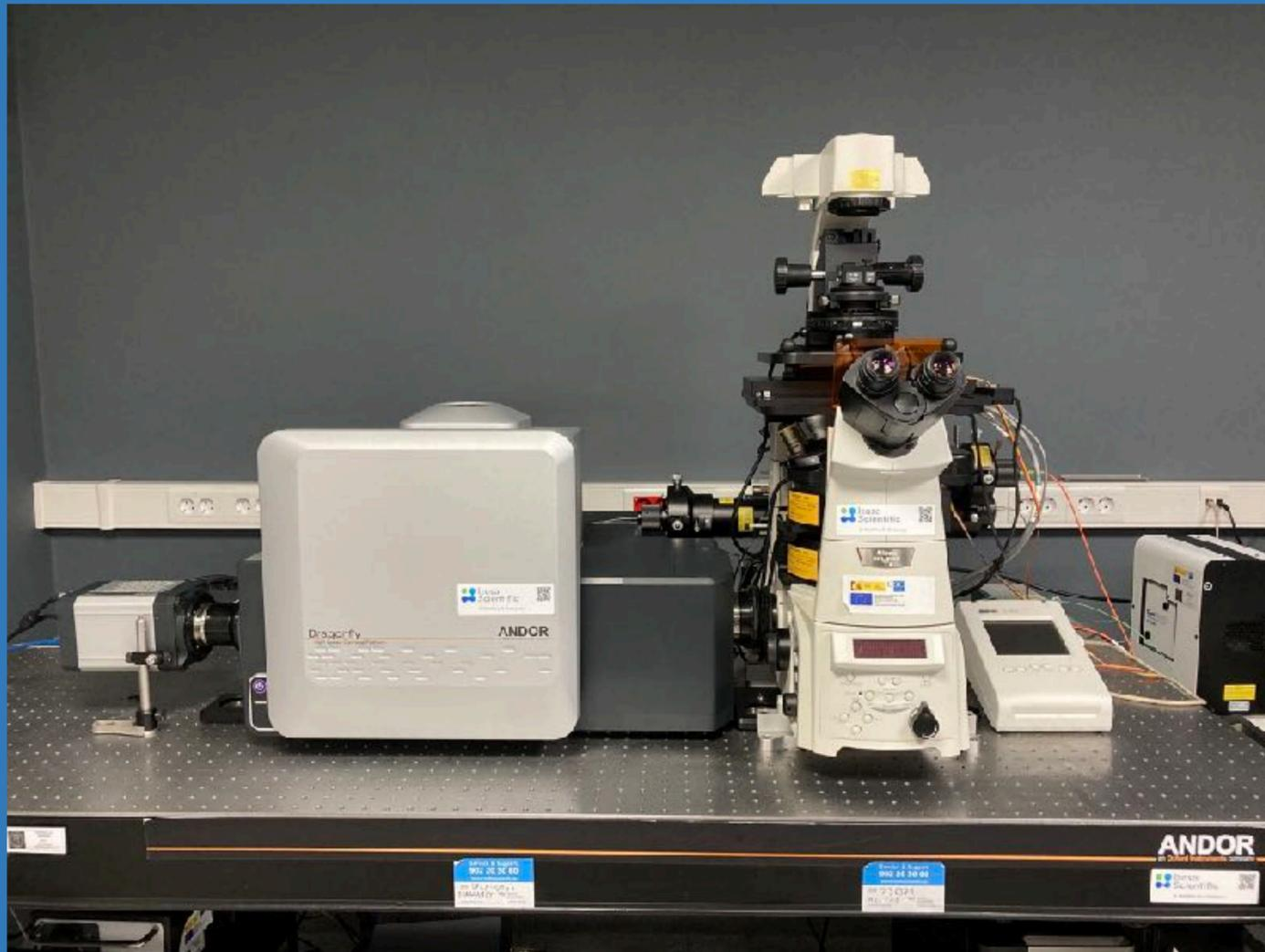
*Sistema que permite la adquisición de imágenes con diferente longitud focal eliminando los puntos de la imagen que quedan fuera de foco. De esta forma, es posible tomar imágenes a diferente profundidad en las muestras celulares y reconstruir imágenes tridimensionales. Acoplado al sistema spinning disk permite obtener imágenes 3D en tiempos muy bajos.*
