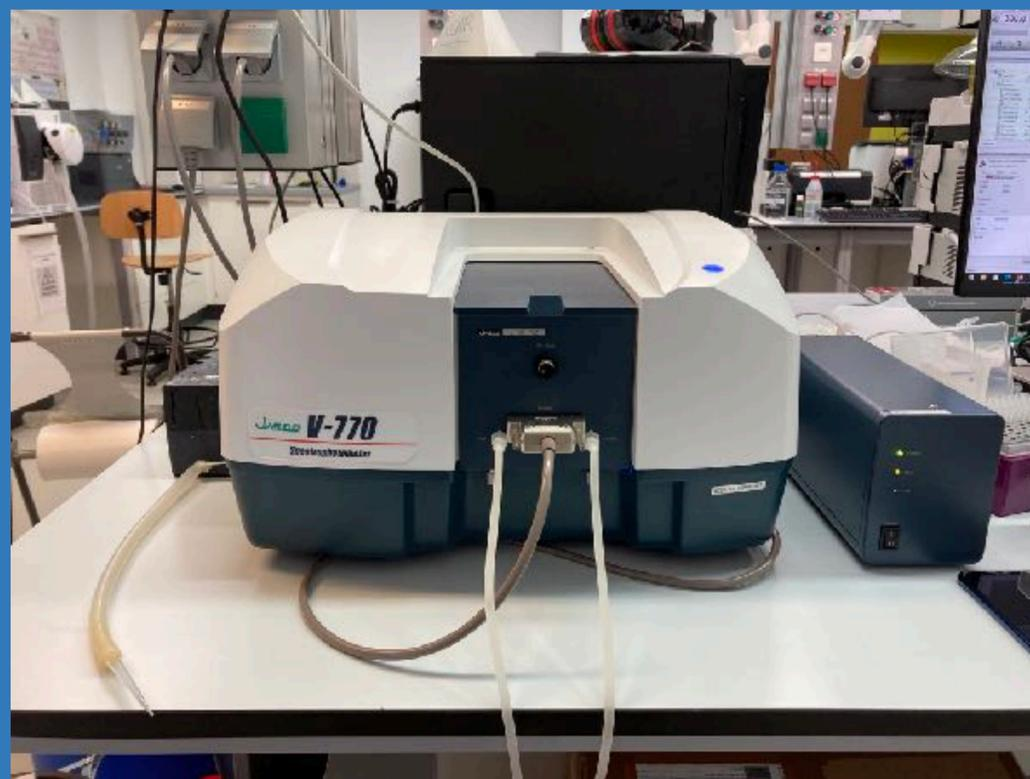
*Conjunto de técnicas que diseñadas para el estudio de la cantidad de radiación absorbida o transmitida por un compuesto, generalmente en disolución. Permite conocer la concentración de los compuestos en disolución a través de la ley de Lambert-Beer, así como determinados aspectos de su estructura tridimensional o interacciones intermoleculares*
