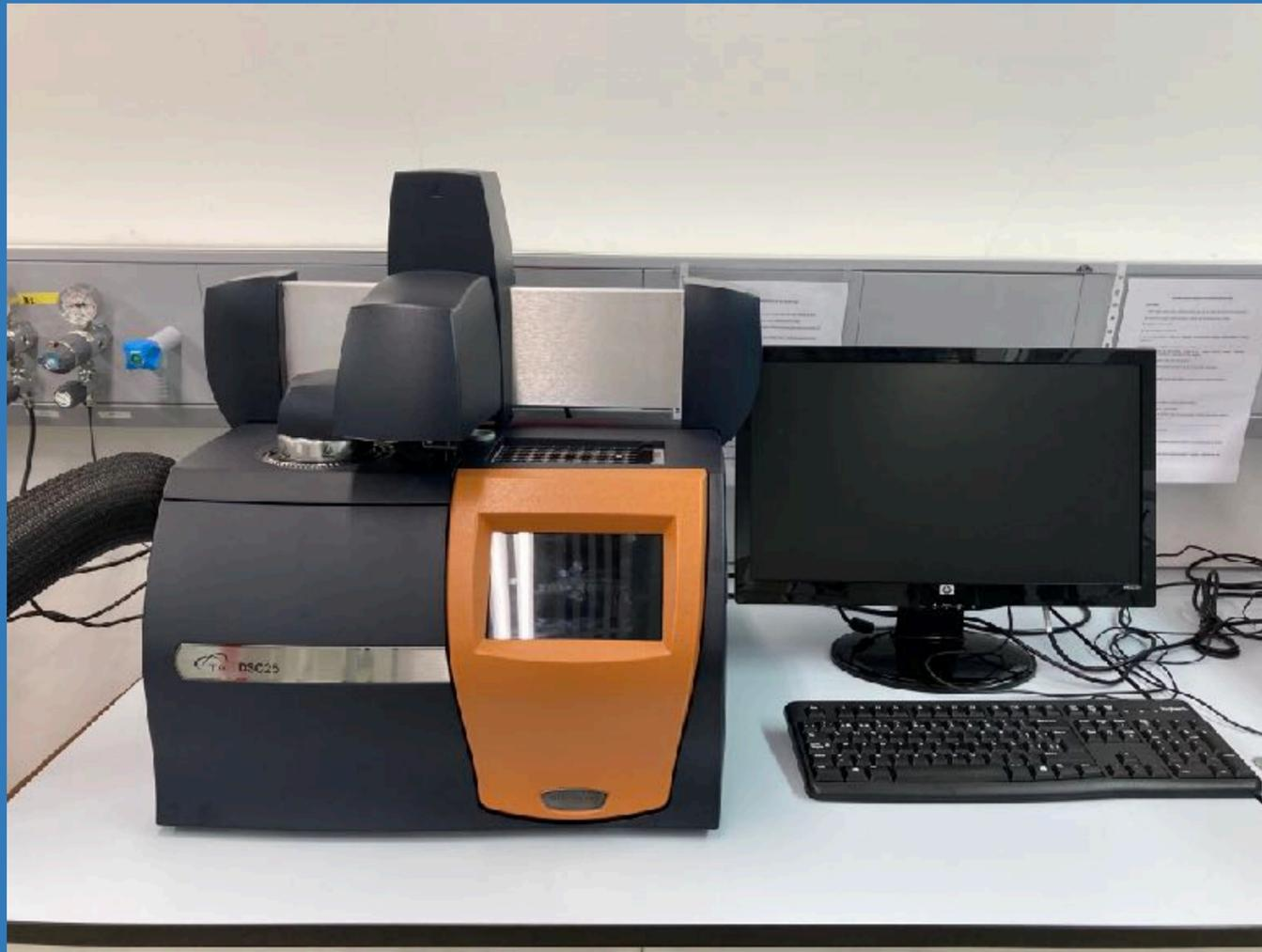
*Conjunto de técnicas para el estudio de los cambios en las propiedades de los materiales (flujo de calor, diferencia de masa, el cambio de dimensiones o las propiedades mecánicas) en función de la temperatura. Es posible conocer parámetros tales como el coeficiente de expansión térmica, la temperatura de transición vítrea, la temperatura de fusión o cristalización, o la higroscopía de un material*
