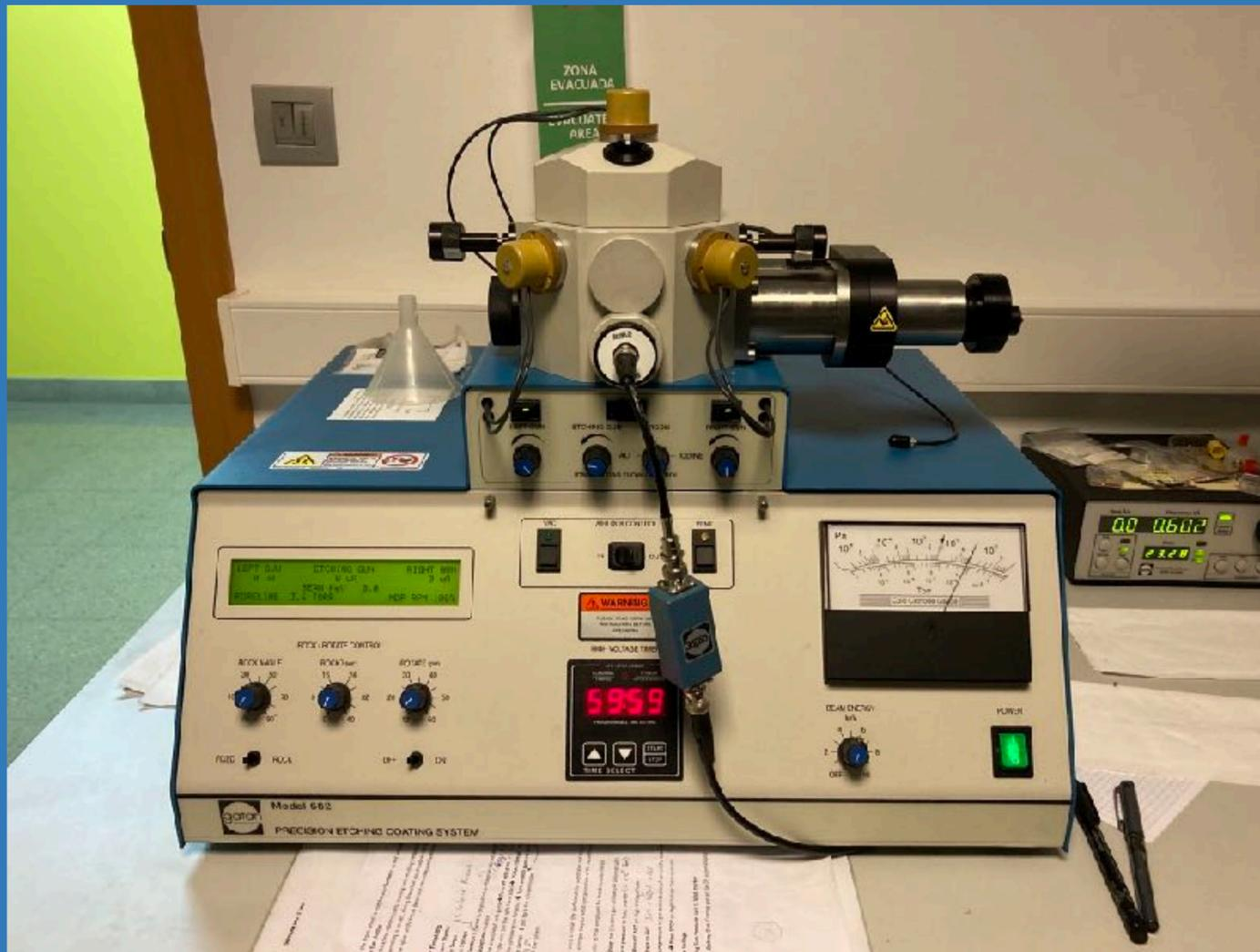
*El sistema de recubrimiento de alta precisión que emplea un proceso de pulverización catódica promovida por argón. Con este equipo se pueden depositar capas de materiales metálicos o dieléctricos de pocas micras de espesor sobre materiales como oro, platino, carbono o sílice*
