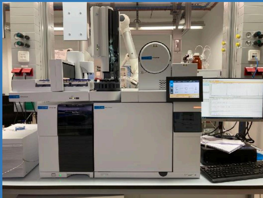
*La cromatografía de gases es una técnica cromatográfica de separación y análisis de compuestos en función de su volatilidad y polaridad. Combinada con la detección de masas (MSD) se convierte en la técnica idónea para la identificación y caracterización de los productos y subproductos obtenidos durante el desarrollo de nuevos catalizadores y métodos sintéticos*
