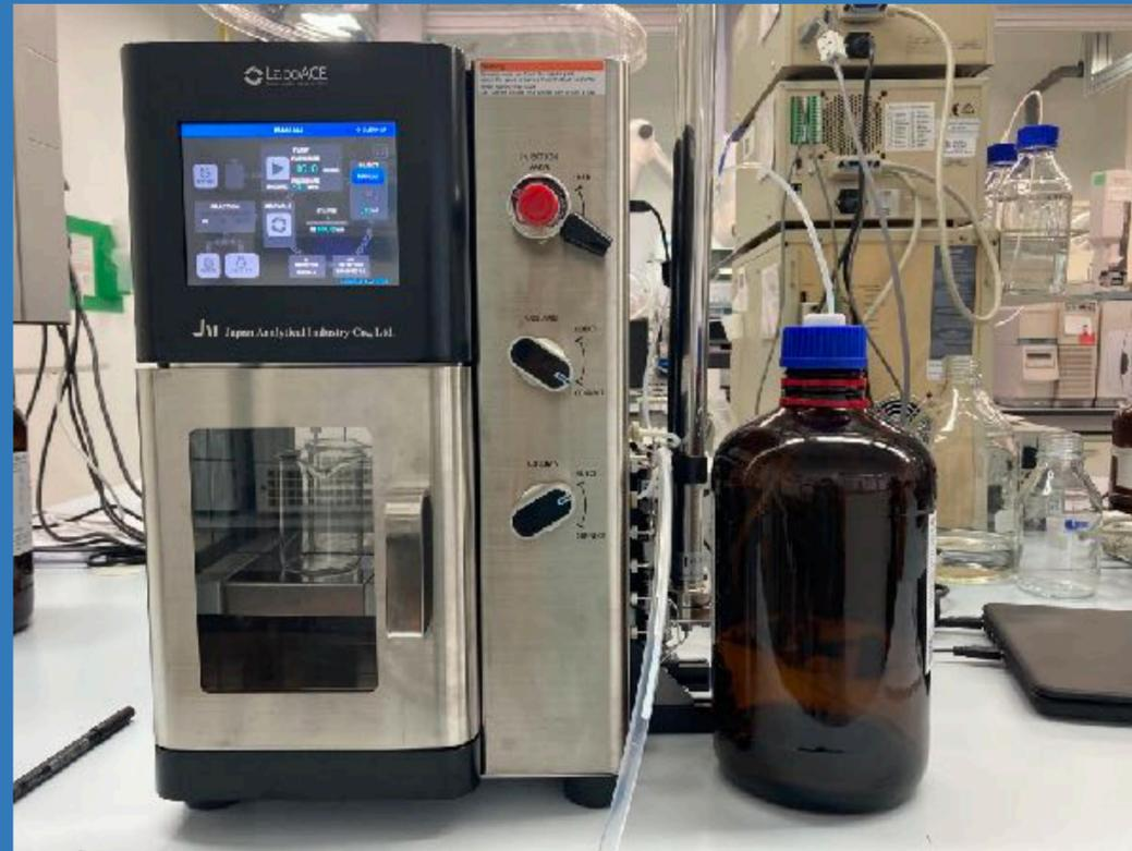
*La cromatografía de permeación en gel (GPC) es una técnica analítica empleada para separar macromoléculas disueltas en base a su tamaño en elución a través de columnas de exclusión por tamaño. Mediante el uso de GPC es posible medir el peso molecular, el tamaño molecular y la viscosidad intrínseca. Además es una técnica escalable a nivel preparativo para la purificación de compuestos en escala de gramo.*
