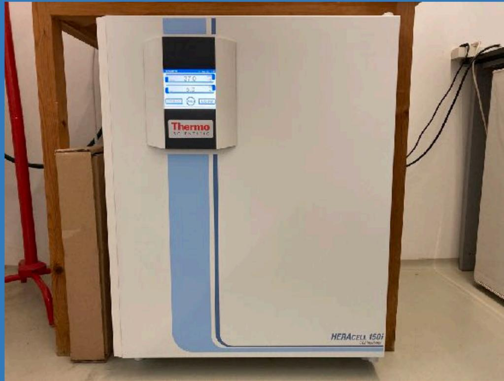
*Equipos destinados al desarrollo de cultivos celulares. Para ello, poseen un compartimento aislado del exterior, capaz de mantener unas condiciones constantes de temperatura, de pureza de atmósfera y de concentración de dióxido de carbono*
