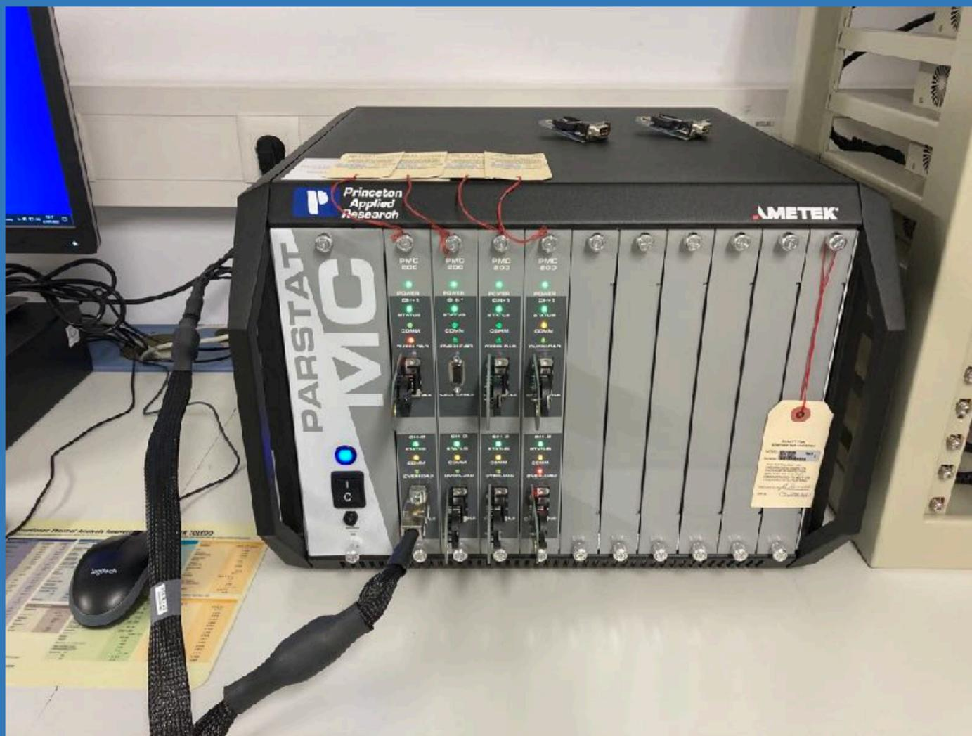
*Sistema de análisis electroquímico con capacidad para medir hasta 8 canales en paralelo (ampliable a 32 canales). Este sistema puede medir la resistencia de las baterías a lo largo de su vida útil simulando ciclos de carga y descarga*
