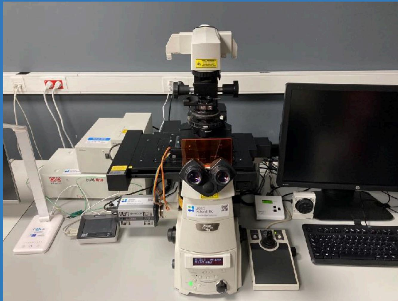
*Tipo de microscopía óptica que emplea la capacidad de los de emisión de los compuestos fluorescentes para formar una imagen de fluorescencia. De esta forma se pueden observar fácilmente marcadores fluorescentes en el interior de células o tejidos.*
