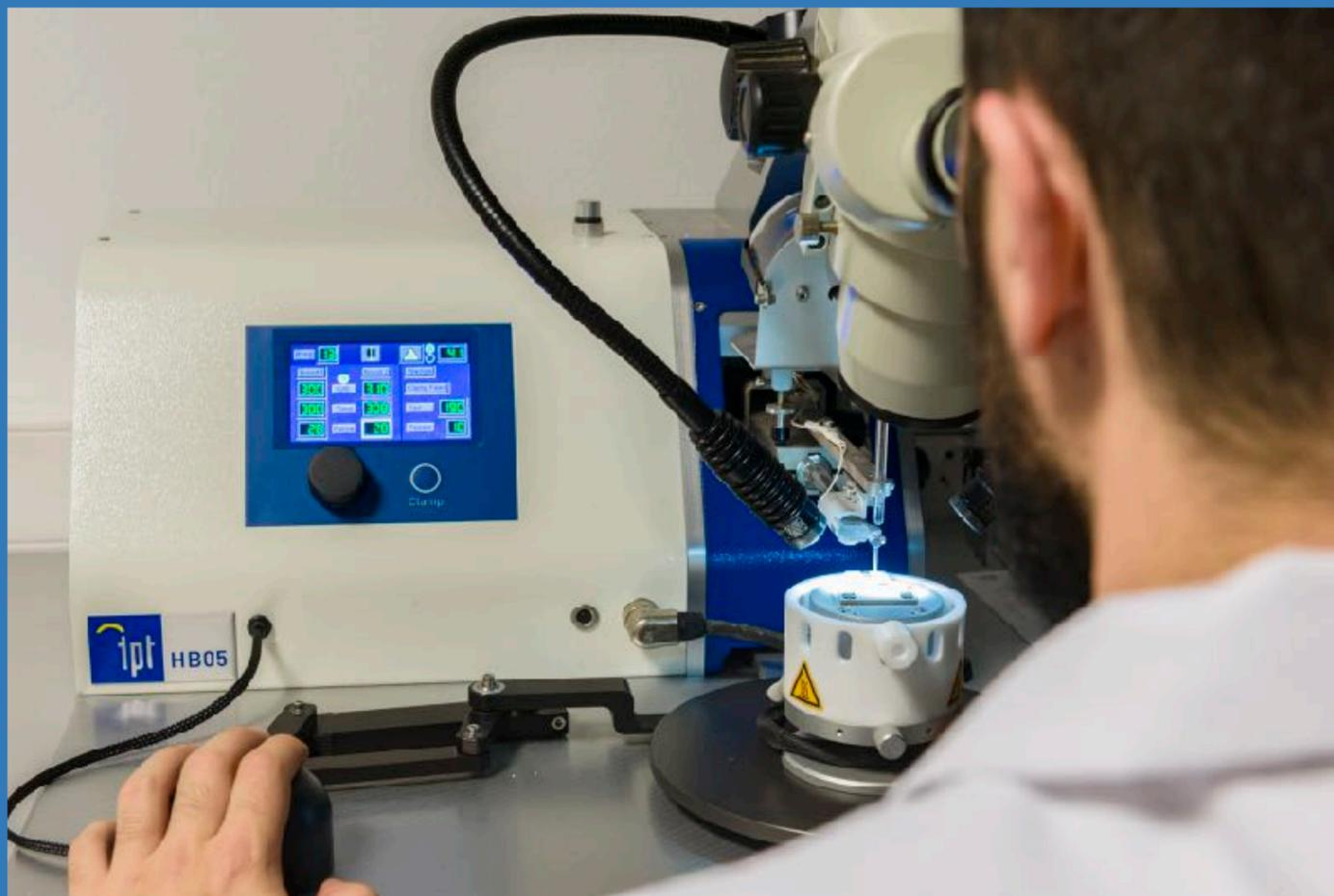
*Equipamiento usado para la microsoldadura de precisión de cables de diámetros micrométricos sobre semiconductores, de cara al posterior estudio de sus propiedades térmicas y magnéticas*
