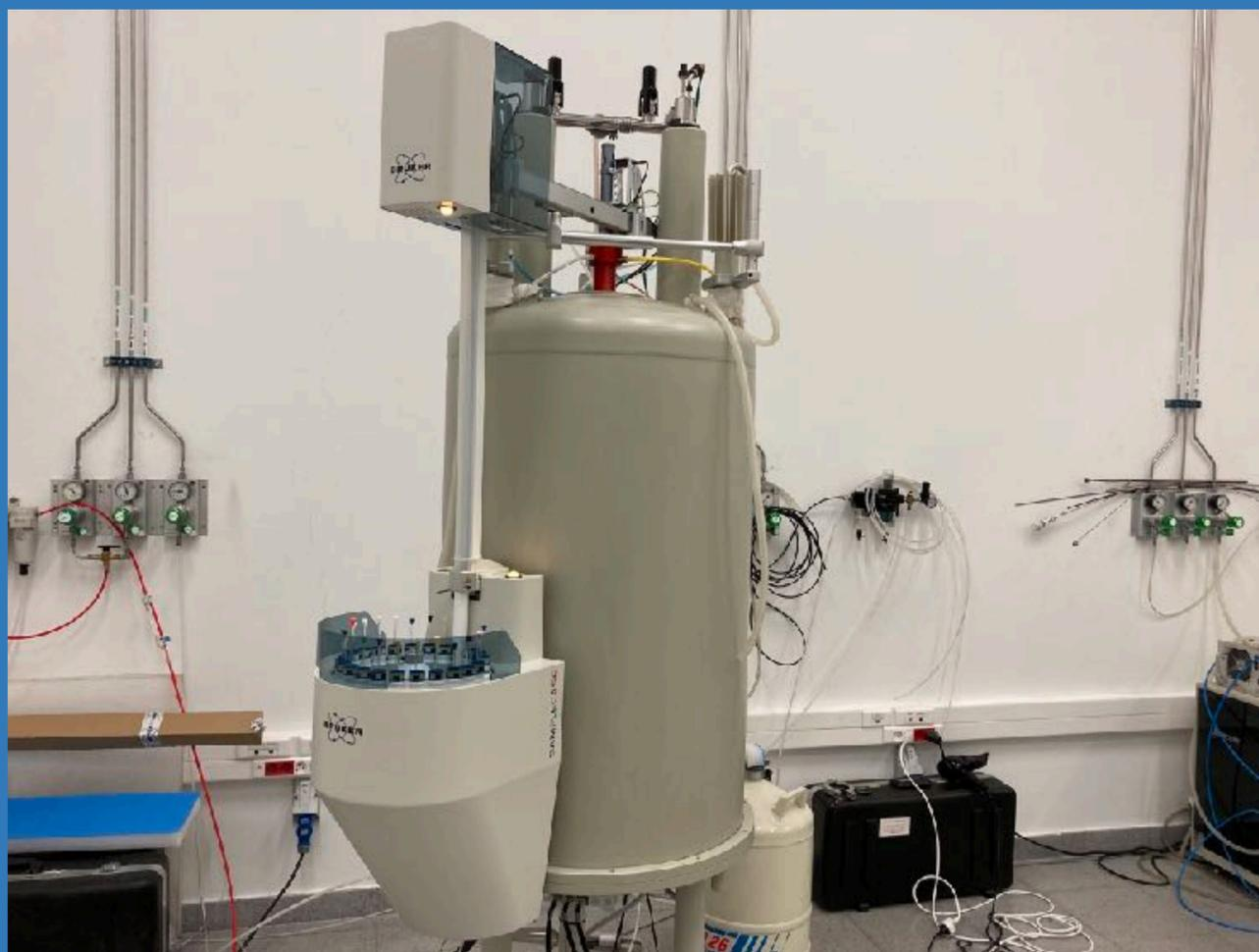
*Técnica que permite medir las interacciones entre núcleos atómicos magnéticamente activos y fuertes pulsos magnéticos. Estas interacciones varían según el entorno químico, por lo que es posible conocer la estructura de los compuestos y sus interacciones intra- o intermoleculares. Estos equipos forman parte de la Red de Infraestructura de Apoyo a la Investigación y al Desarrollo Tecnológico (RIAIDT) de la USC y están supervisados por el personal técnico del Servicio de RMN de la USC*
