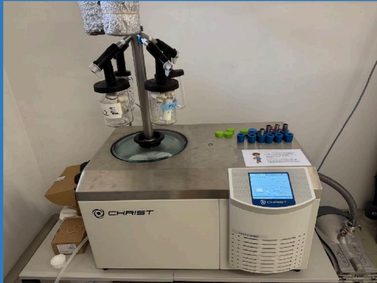
*Equipos que permiten deshidratar muestras en condiciones de baja presión y temperatura. En el proceso de liofilización, el agua en estado sólido pasa directamente a vapor mediante un proceso de sublimación*
