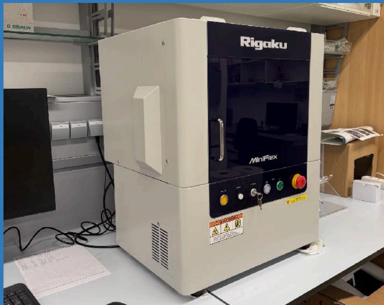
*Difractómetro de rayos X de sobremesa para el análisis de polvo cristalino, con capacidad para la identificación de fases cristalinas, el porcentaxe de cristalinidad, el refinamento de parámetros de red, refinamento de Rietveld, o la estrutura molecular*
