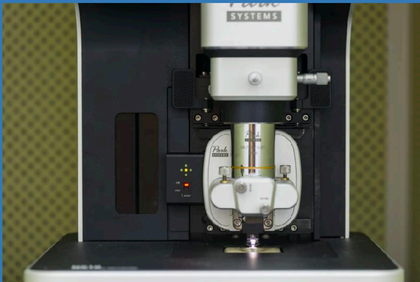
*La técnica de AFM permite la medida tridimensional de la superficie de muestras a escala nanométrica mediante las interacciones con una sonda mecánica. De esta forma, es posible formar imágenes de las superficies o incluso manipular moléculas. También puede medir la conductividad de los materiales depositados sobre las superficies*
