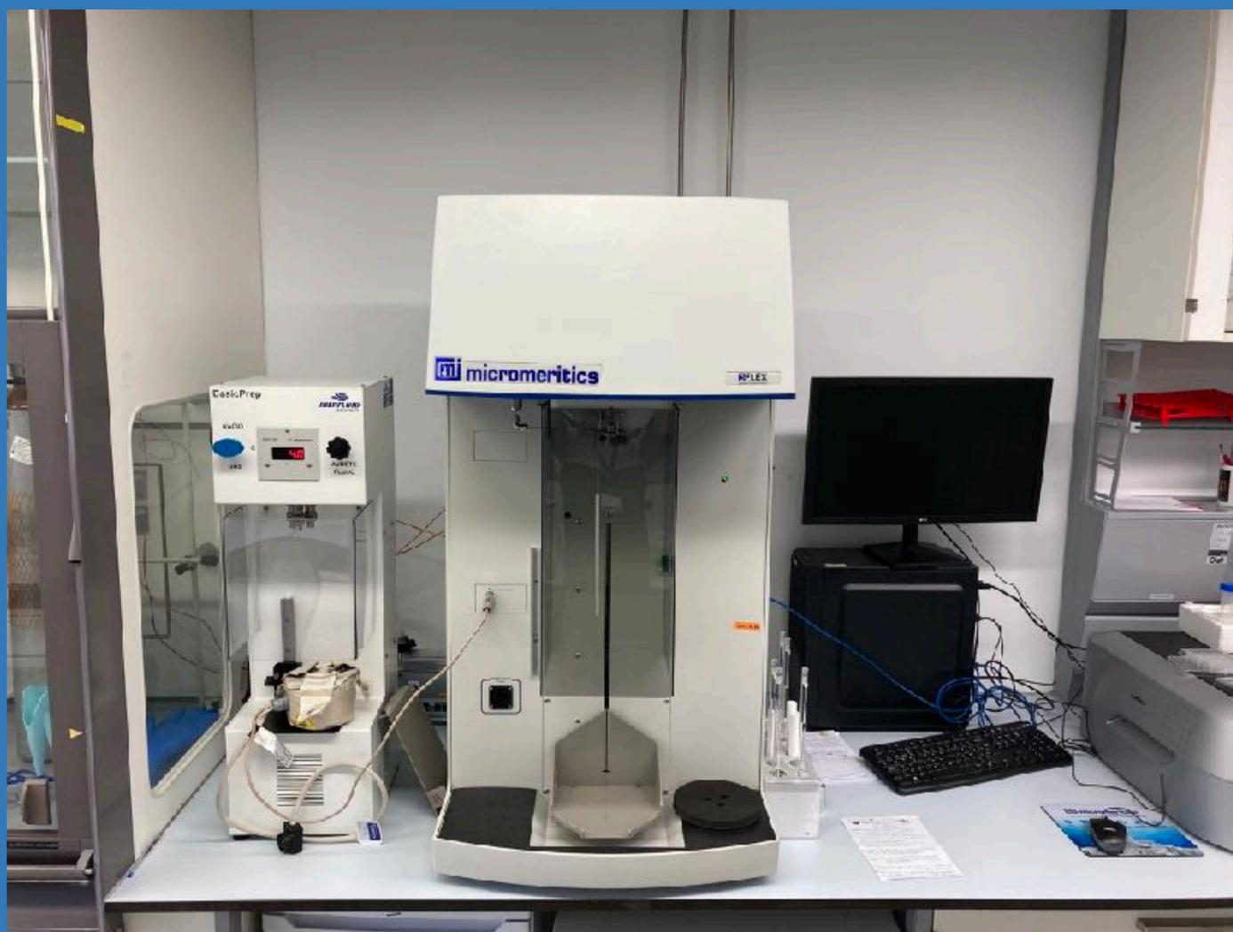
*Instrumento diseñado para medir el área de superficie, el tamaño de poro y el volumen de poro da partículas. Se pueden usar métodos estándar o protocolos ajustados por el usuario para caracterizar adsorbentes, catalizadores, zeolitas, MOFs, etc. Con tamaños de poro comprendidos entre 2 y 50 nm*
