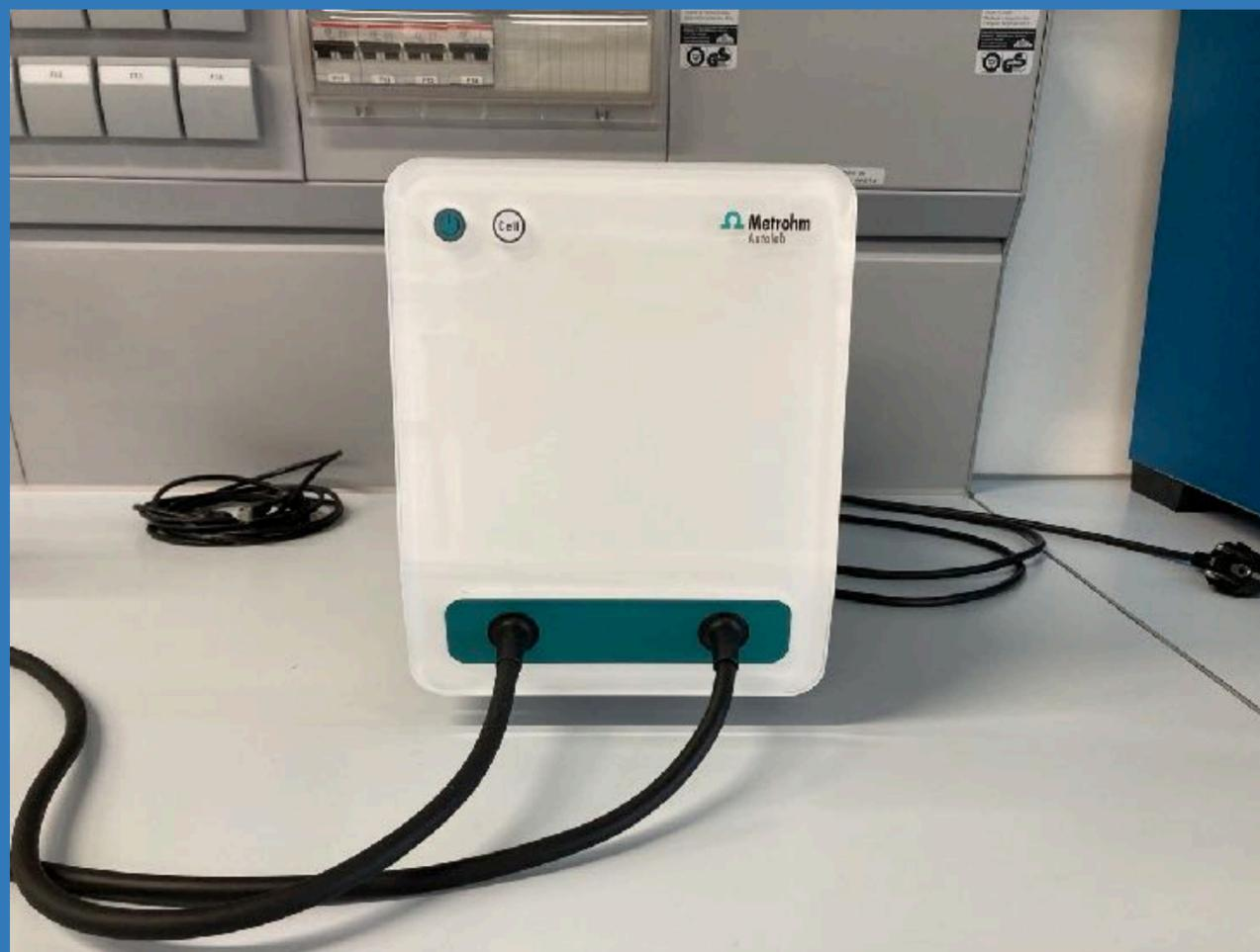
*Sistema electroquímico que permite estudiar procesos redox y propiedades eléctricas de materiales. Además, mediante espectroscopía de impedancia electroquímica (EIS), permite caracterizar procesos de transferencia de carga, difusión y otras propiedades electroquímicas. Esta técnica es ampliamente utilizada en el estudio de baterías, corrosión de materiales, sensores y catálisis.*
