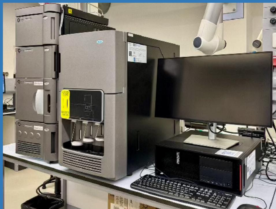
*Técnica que permite el análisis y la separación de mezclas de compuestos en función de sus tamaño y polaridad. Unida a la detección de masas (MSD) se convierte en la técnica idónea para la identificación y caracterización de compuestos con pesos moleculares relativamente altos, péptidos y macromoléculas.*
