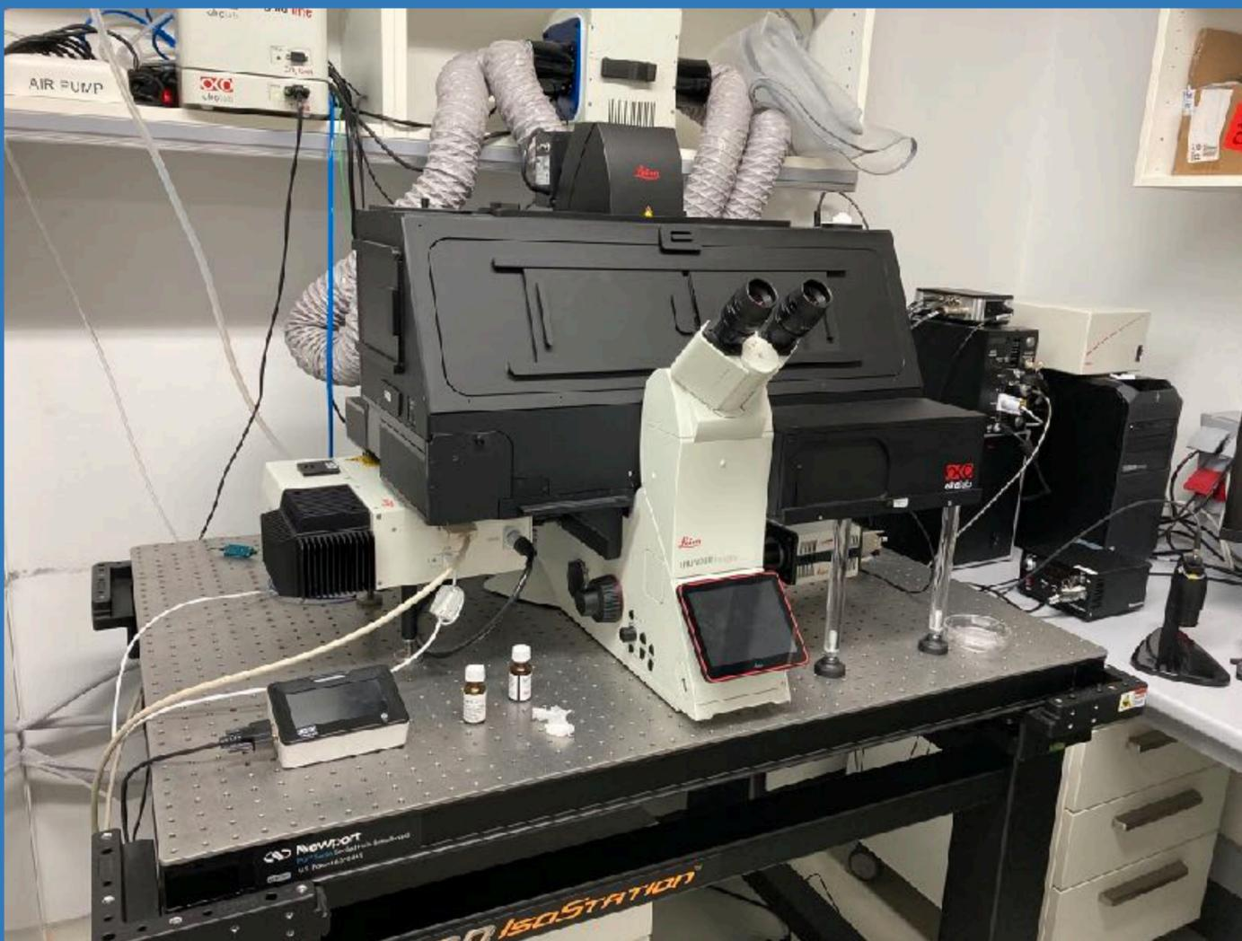
*Sistema diseñado para el estudio tridimensional de tejidos, organoides y cultivos celulares mediante técnicas "computational clearing", que elimina los puntos desenfocados en tiempo real. También permite aplicar técnicas de fotoestimulación y fotomanipulación de determinados materiales empleando láseres que irradian en la región NIR.*
