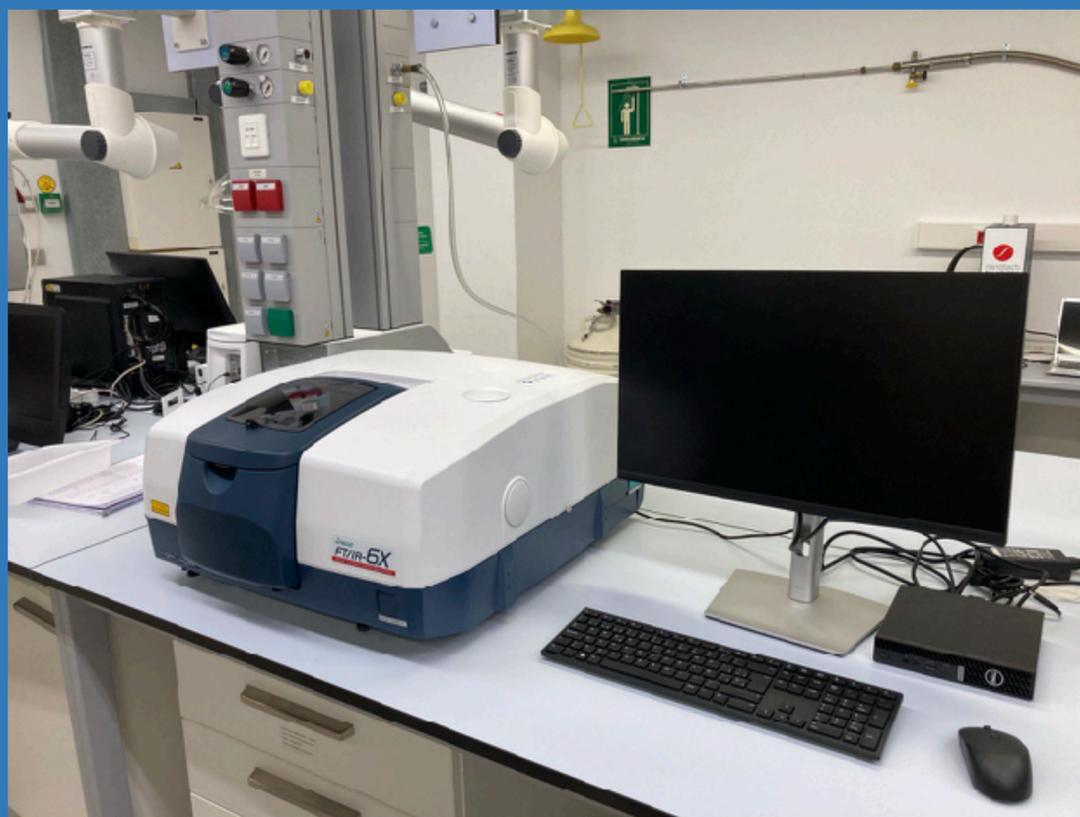
*Conjunto de técnicas diseñadas para medir la interacción entre los compuestos (ya sea en estado sólido o disolución) y la radiación infrarroja. Permite conocer los diferentes grupos funcionales presentes en las moléculas, así como las interacciones entre ellos. Es una técnica útil para la caracterización de compuestos o la identificación de muestras desconocidas*
