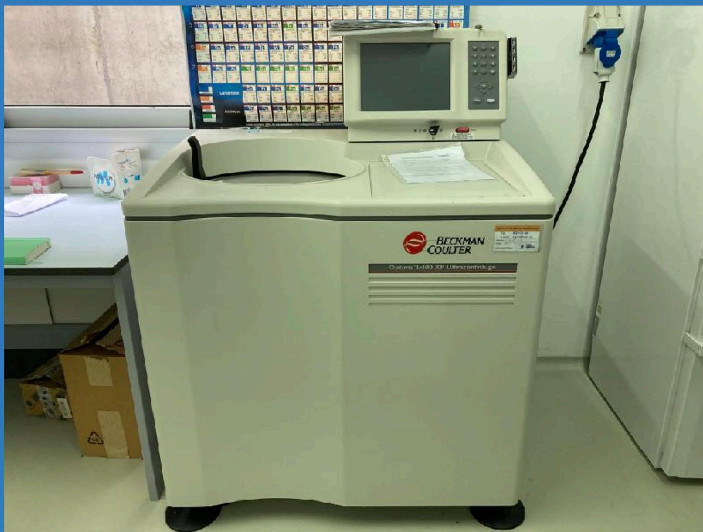
*Centrifugadora optimizada para alcanzar aceleraciones de hasta 800 g a regímenes de hasta 100.000 rpm. El compartimento del rotor es termostatizable (5 – 40 °C) y se encuentra a baja presión para minimizar el rozamiento*
