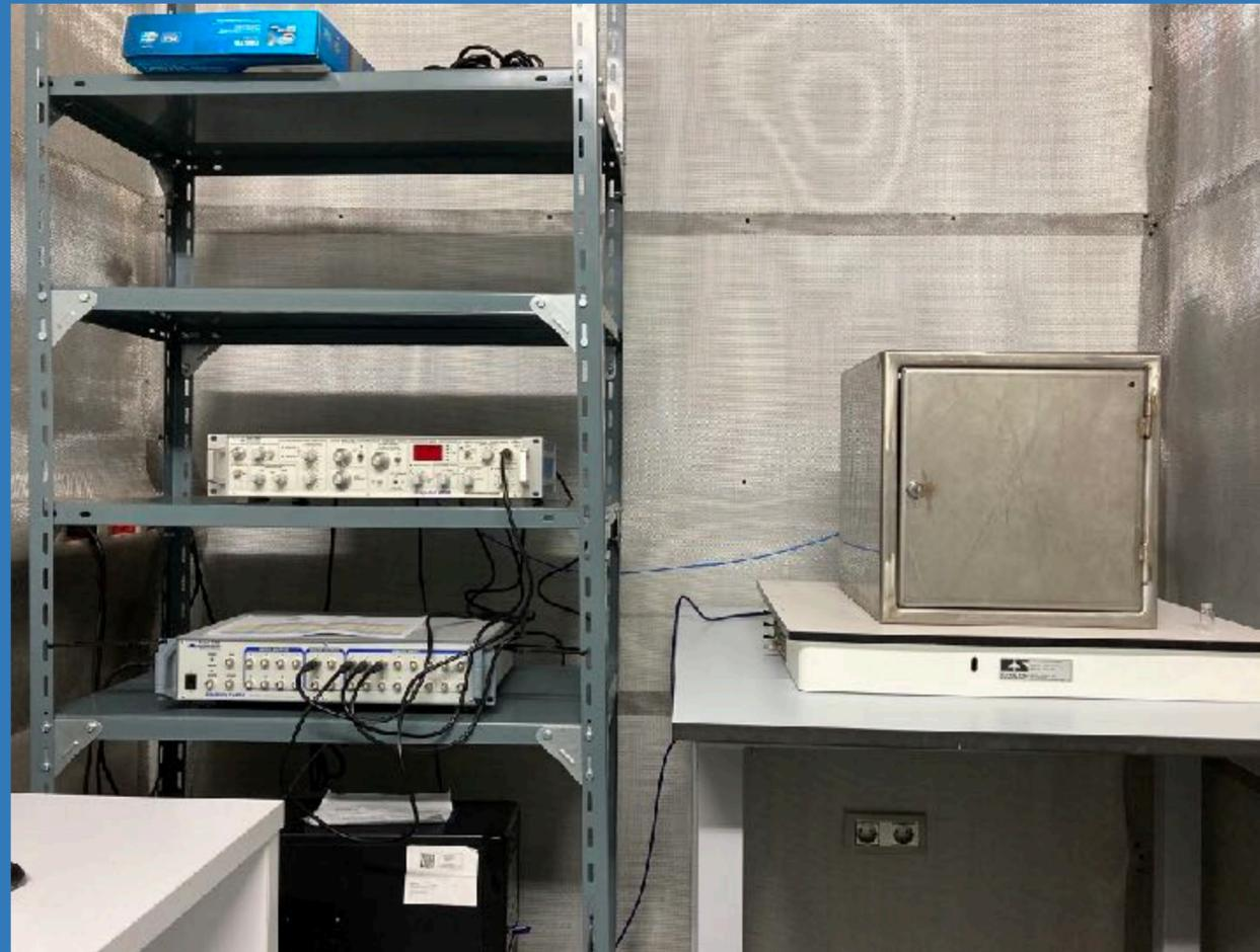
*Instrumento diseñado para registrar los cambios de diferencia de potencial que provoca el tránsito de iones y otras especies a través de membranas celulares convenientemente fijadas en superficies*
