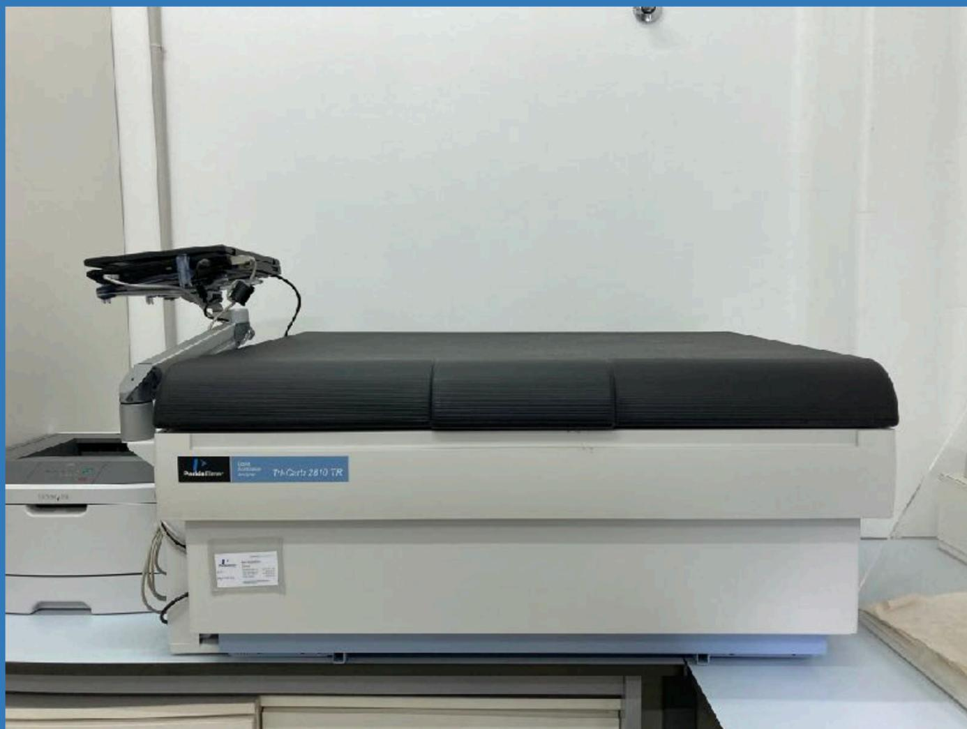
*Instrumento diseñado para medir pequeñas trazas de radiación alfa, beta o gamma. Posee un detector que produce un centelleo (emisión de luz) cuando es atravesado por una partícula o un ion. Puede ser programado con diferentes protocolos de medida para automatizar la medida de hasta 400 muestras*
